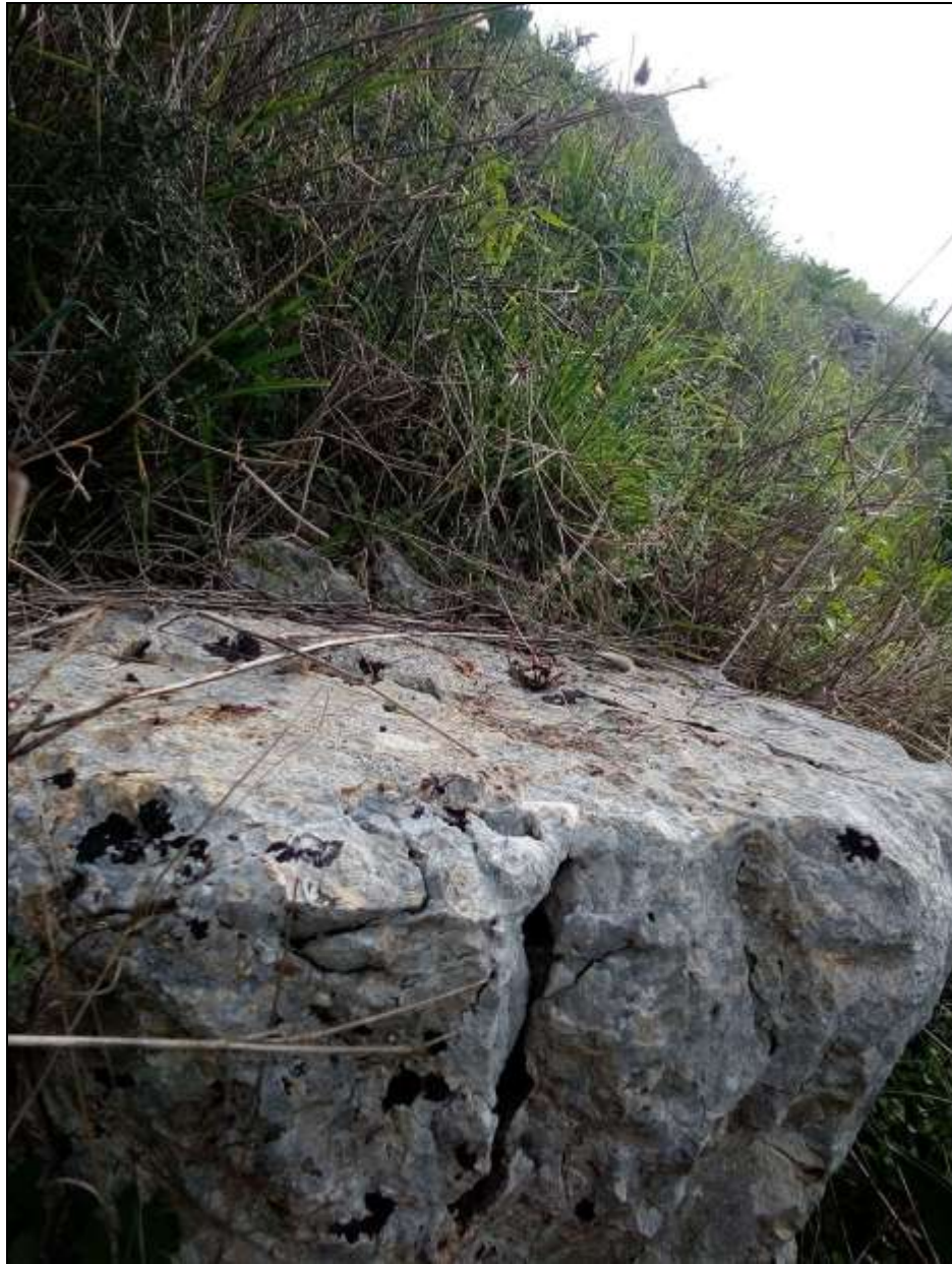
Fig. 9e – Osservazione della rugosità del giunto.
