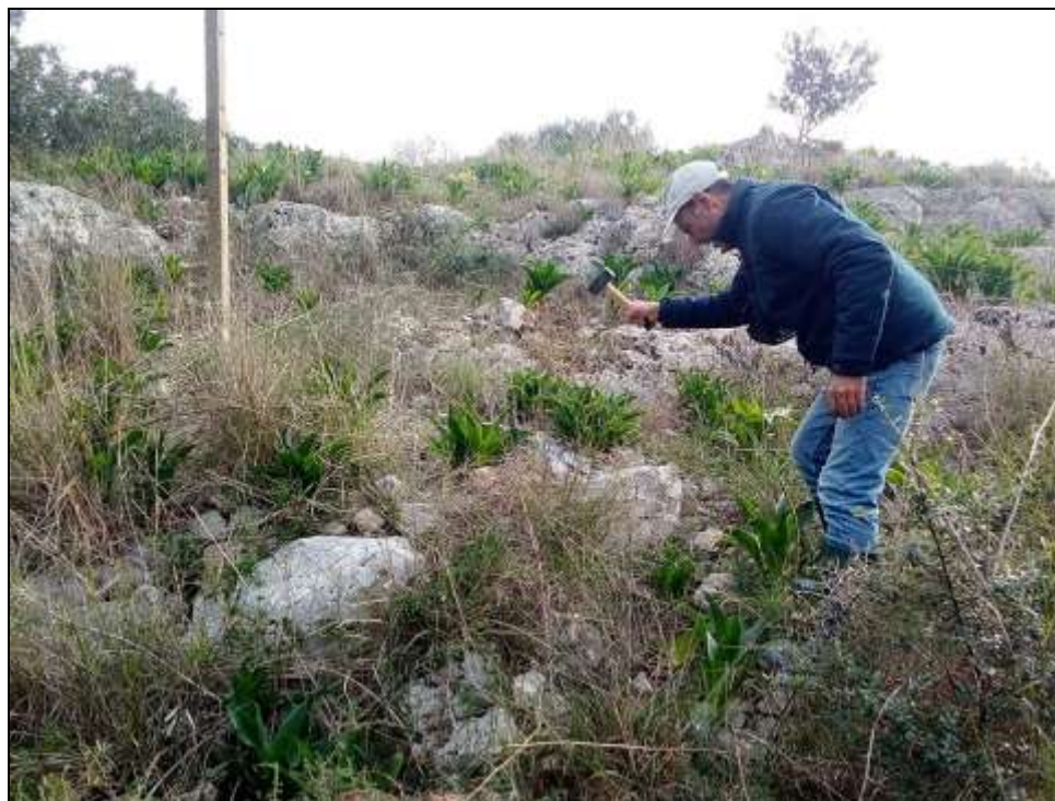
Fig. 9a – Risposta della roccia alla percussione con il martello.
