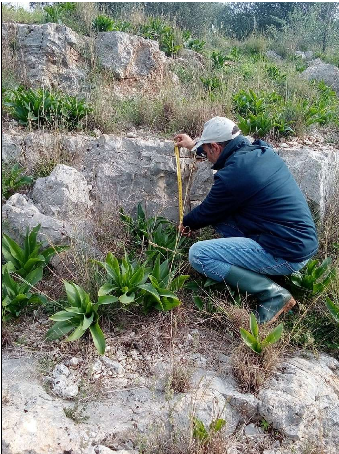
Fig. 9b – Misura del valore medio della spaziatura tra due discontinuità adiacenti.
