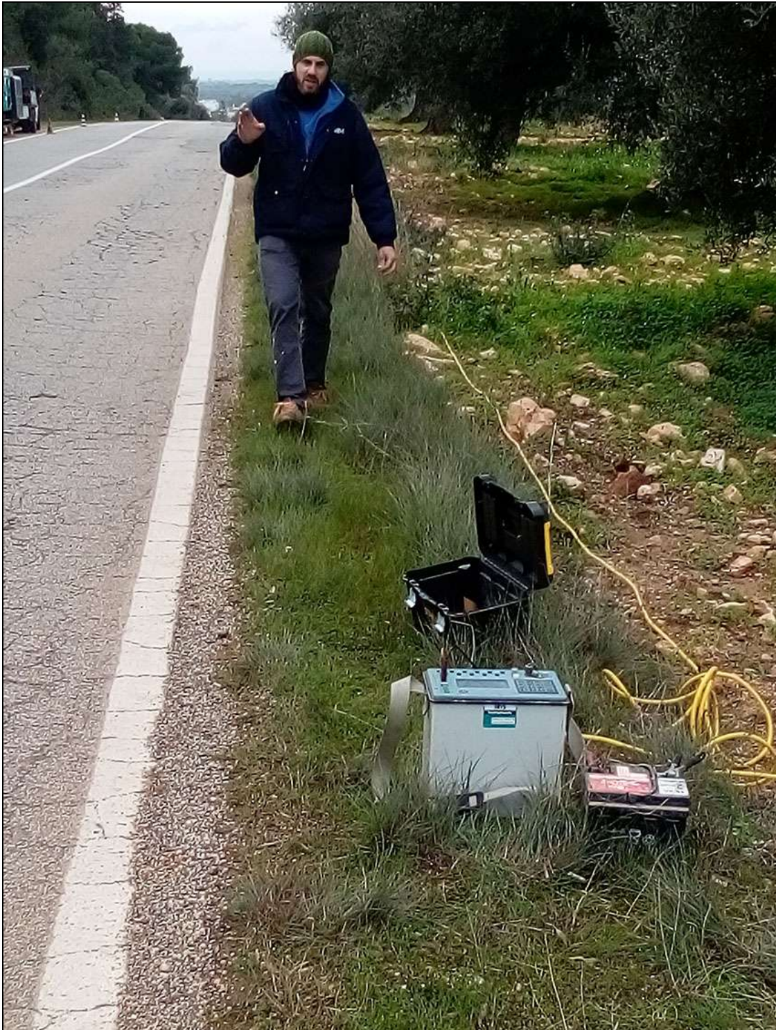
Fig. 6d – Indagine geoelettrica eseguita nei pressi del ciglio stradale destro, andando verso Maruggio.
