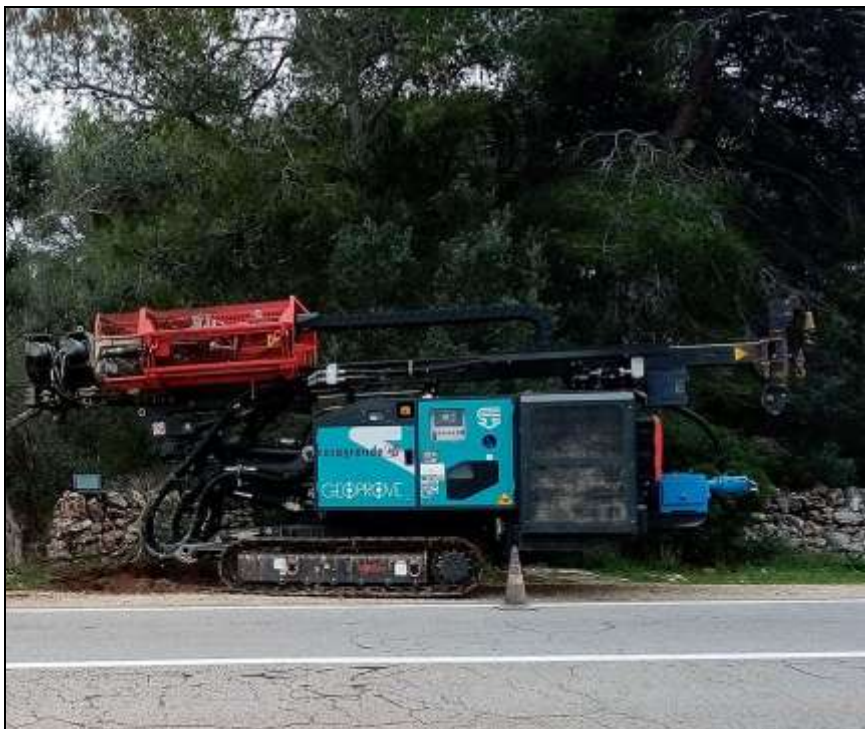
Figg. 6a e 6b – Messa in opera della macchina perforatrice per eseguire il sondaggio a carotaggio continuo.
