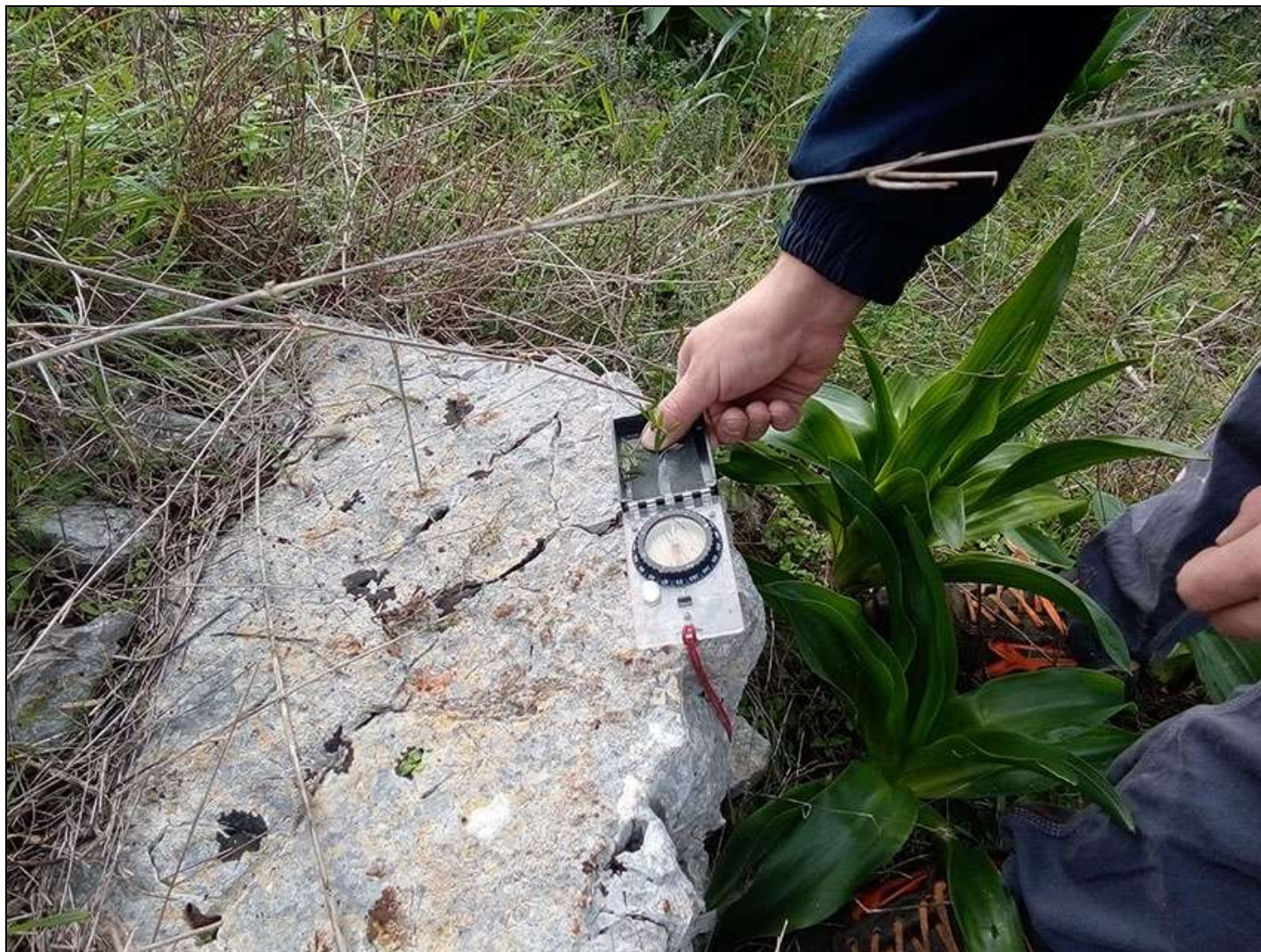
Fig. 9i – Giacitura degli strati “a monoclinale” dell’ammasso roccioso.
