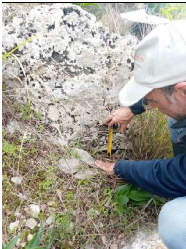
Fig. 9d – Misura del valore dell’apertura o beanza del giunto.
