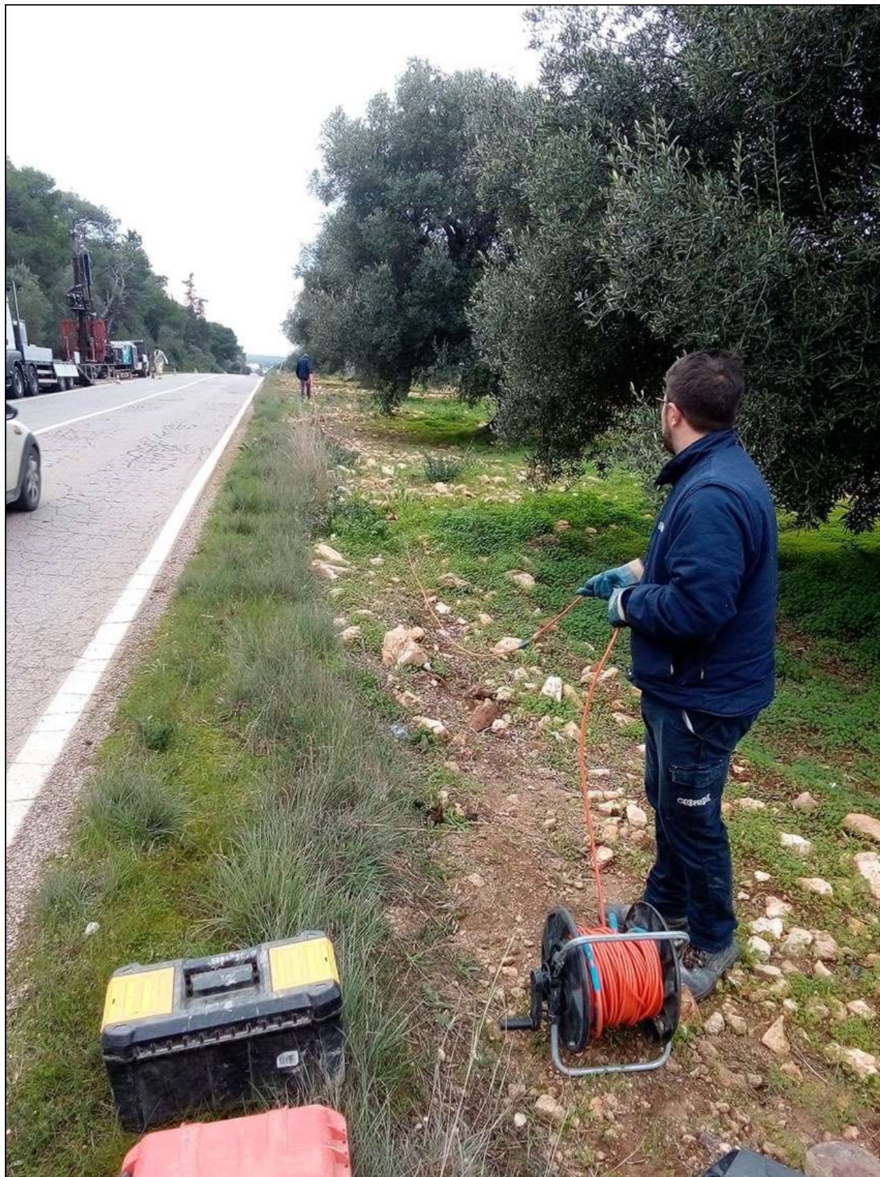
Fig. 6c – Indagine sismica eseguita nei pressi del ciglio stradale destro, andando verso Maruggio.
