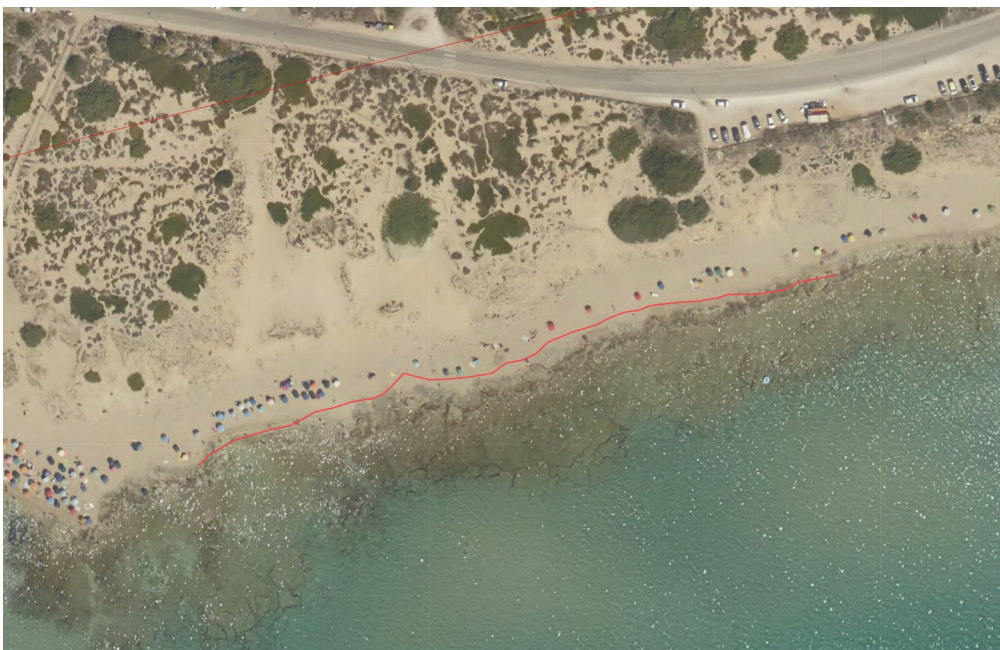
Imm. 4 Linea di riva anno 2005 (tratto ad Alta Criticità immediatamente ad ovest del porto di Campomarino) su Ortofoto 2017. La spiaggia sabbiosa appare in avanzamento.
